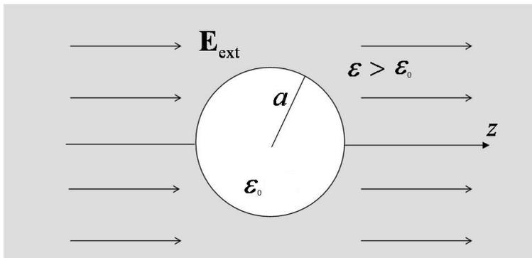
Figura 1: En esta figura  $\epsilon$  y  $\epsilon_0$  denotan la permitividad eléctrica del material y del vacío, respectivamente.  $a$  es el radio de la cavidad esférica.
